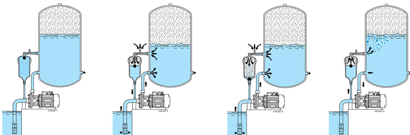
1) При отключённом насосе ARIAMAT заполнен водой.
